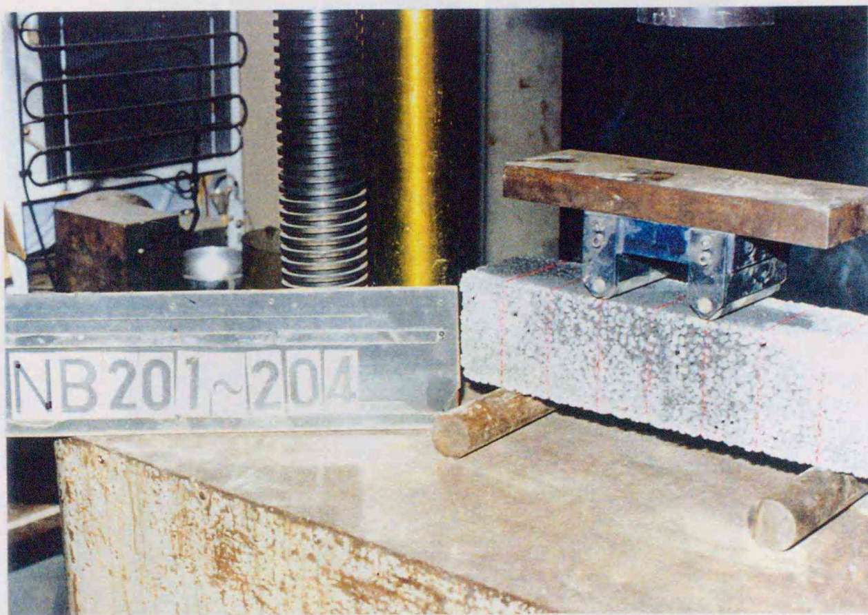
Photo 4.2 3等分点载荷による曲げ試験
