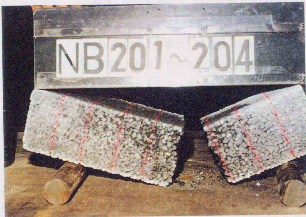
Photo 4.3 3等分点载荷による曲げ破壊
