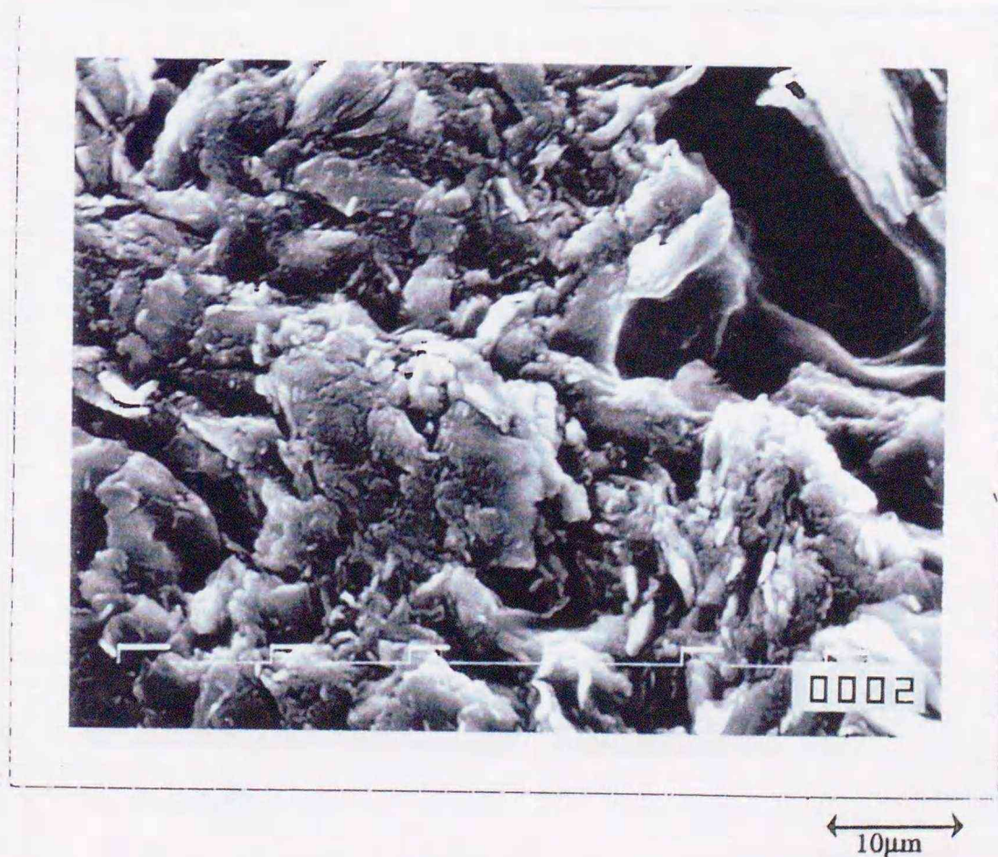
Fig. 2-37 水素イオンを照射した後の等方性黒鉛の表面形態
