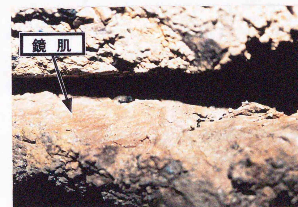
写真-2.2 F 粘土層の上面に観察される鏡肌
