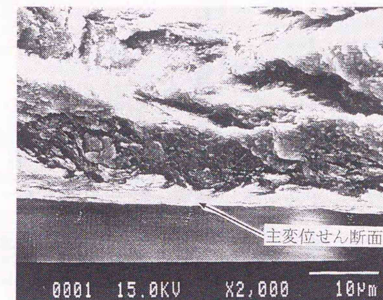
写真-4.9 せん断面付近のSEM像 (プレカット供試体：累積水平変位48mm)
