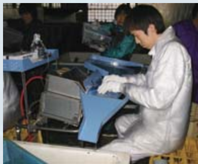
試作注射機を使ってヒラメにワクチンを投与しているところ。
