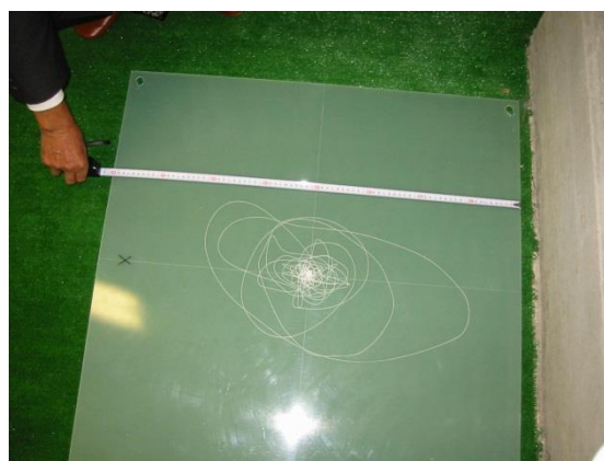
(b) けがき針変位計に記録された 変位オービット
