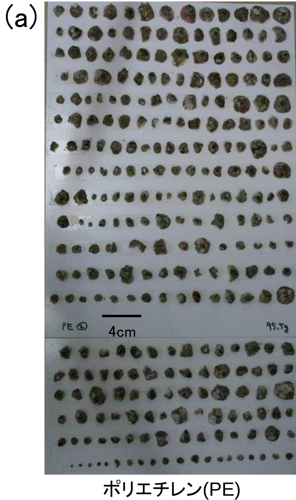
図5 海洋中に各基板を330日間浸漬させた結果 (基板面積: PE 144cm 2 , DNゲル 144cm 2 , PVAゲル100cm 2 ) (a)基板回収後、付着していたフジツボを分離し個体別に並べた写真、(b) 基板表面におけるフジツボの付着面積率 (参考文献8より)
