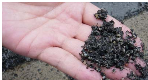
写真 4-2 骨材飛散の状況（左：粗骨材の破壊、右：粗骨材の抜け落ち）
