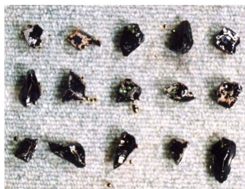
写真 5-2 剥離試験後の粗骨材
