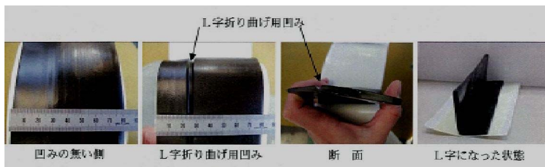
写真 5-8 切削断面用アスファルト止水テープの形状
