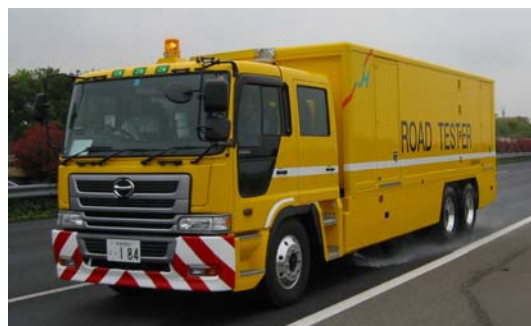
写真 2-4 すべり摩擦測定車
