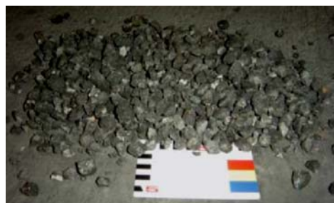
写真 4-2 骨材飛散の状況（左：粗骨材の破壊、右：粗骨材の抜け落ち）
