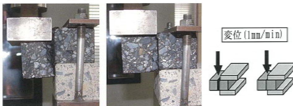
写真 5-9 せん断試験の実施状況
