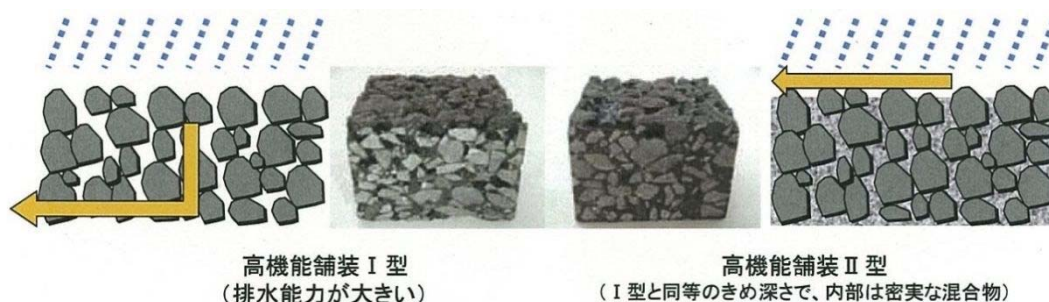
図6-1 高機能舗装Ⅰ型と同Ⅱ型の模式断面図と排水構造の違い
