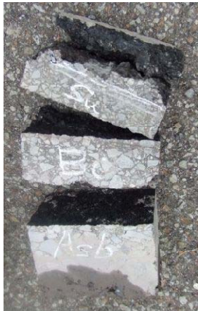
写真 4-20 層間接着力が消失されたアスファルト舗装
