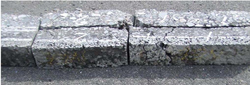
写真 4-20 層間接着力が消失されたアスファルト舗装
