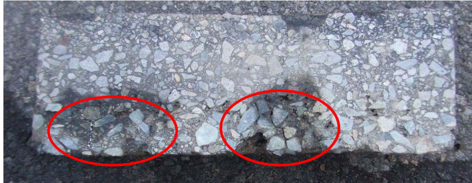
写真 4-17 わだち部のアスベースの緩み
