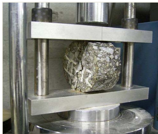
写真 4-7 圧裂試験の状況
