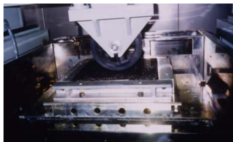
写真2-3 WT試験の状況
