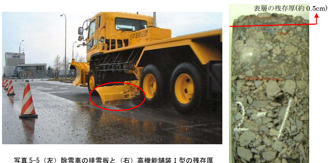
写真 5-4 除雪作業による高機能舗装Ⅰ型の摩耗と骨材飛散状況
