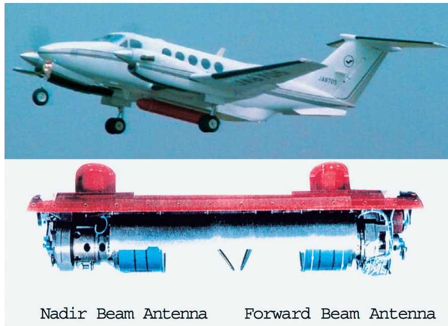
図 3：航空機搭載降雨レーダ (CAMPR)。上：航空機ビーチクラフト 200 に搭載された CAMPR，下：アンテナシステム（前方ビームと直下ビームがあり，機械的走査も可能）。
