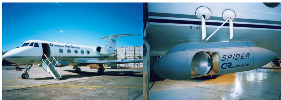
図 4：航空機搭載雲レーダ (SPIDER)。左：航空機 Gulfstream II に搭載された SPIDER，右：アンテナを横向きにしたレーダポッド，離着陸時にはアンテナを収納する。レーダポッド内に送受信部が収容されている。
