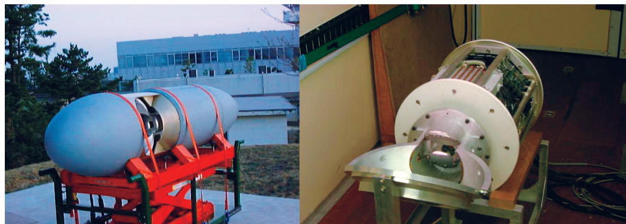
図 9：SPIDER による地上観測。左：レーダポッドの台車を使用した観測，右：送受信部とアンテナを取り出し，専用の台を使った観測。
