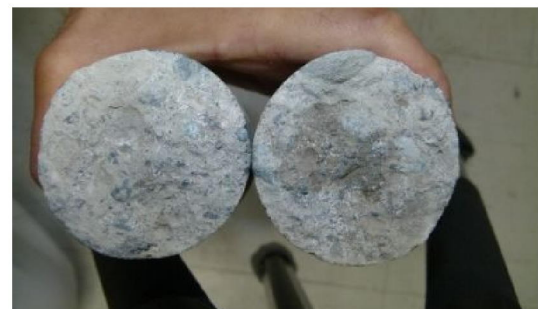
写真 5-25 F 部コア折損断面
