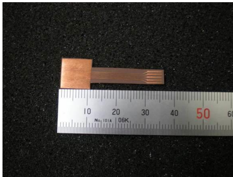
図 3.13 比誘電率推定に使用された電極
