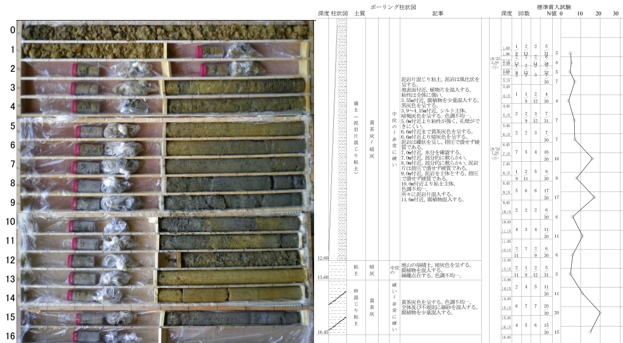
図-3.4.8 ボーリングコアとボーリング調査結果（上信越道上越地区）
