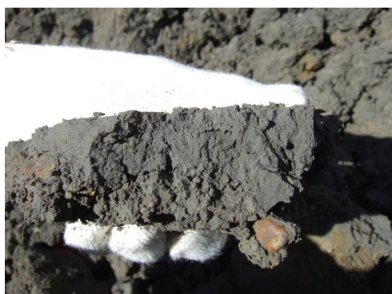
(c) 盛土材料の状態（箇所1 深さ1m）
