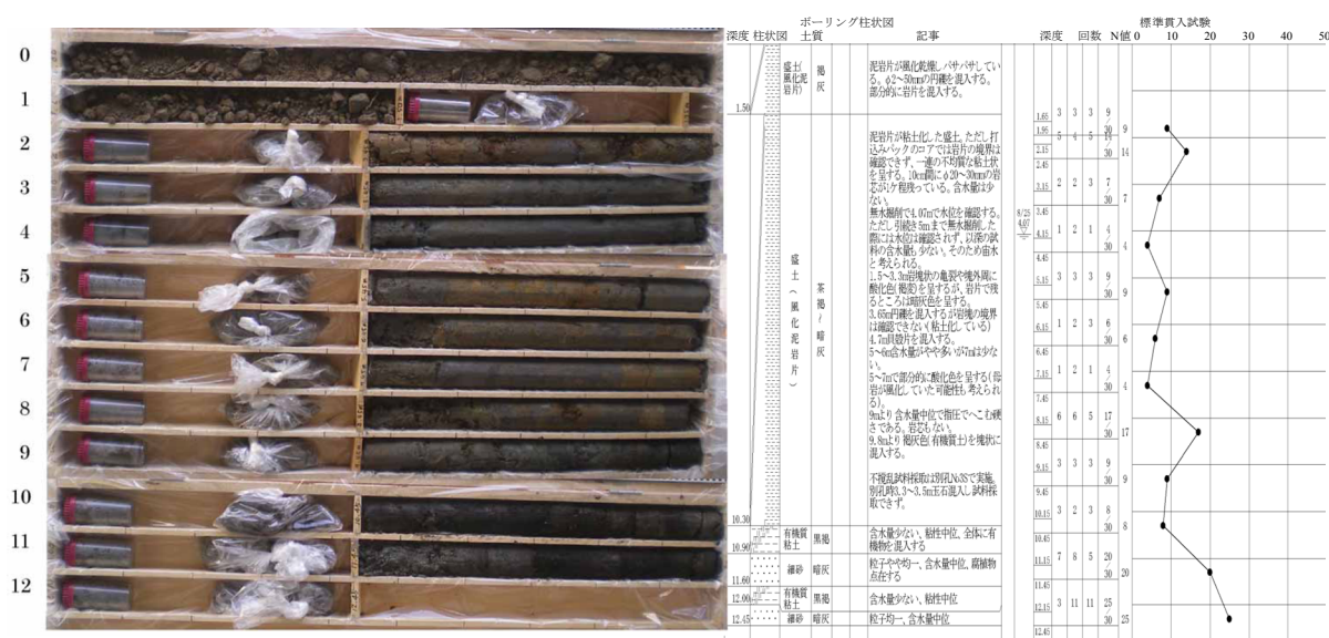
図-3.4.12 ボーリングコアとボーリング調査結果（東名掛川1地区）
