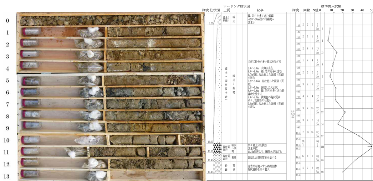
図-3.4.16 ボーリングコアとボーリング調査結果（山陽道神戸 1 地区）
