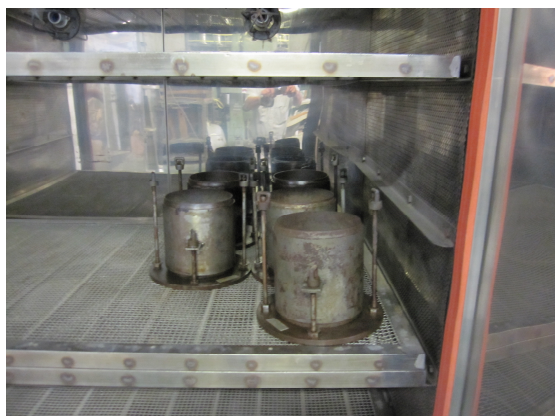
(a) 室内の乾燥炉での乾湿繰返し
