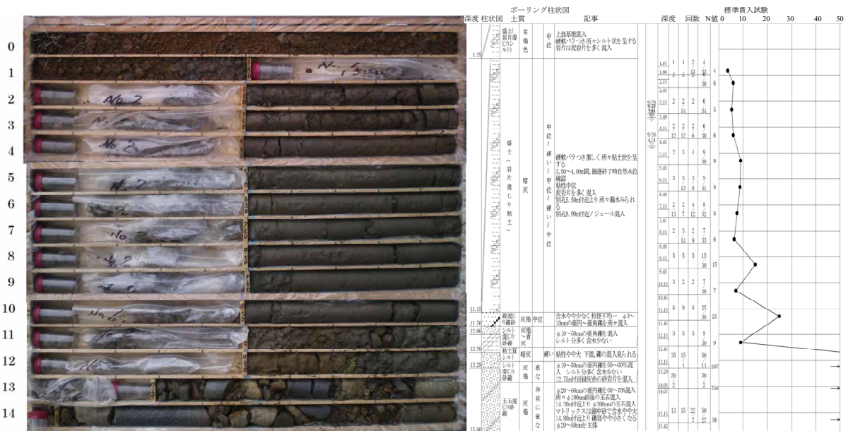
図-3.4.10 ボーリングコアとボーリング調査結果（北陸道能生地区）
