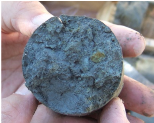
図-3.4.19 ボーリングコア内の礫の混入状況（北陸道能生地区）
