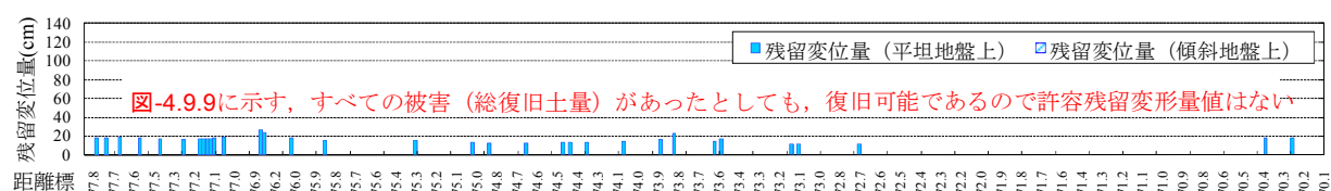
図-4.9.11 残留変形量と許容残留変形量 (平坦部の代表IC間)
