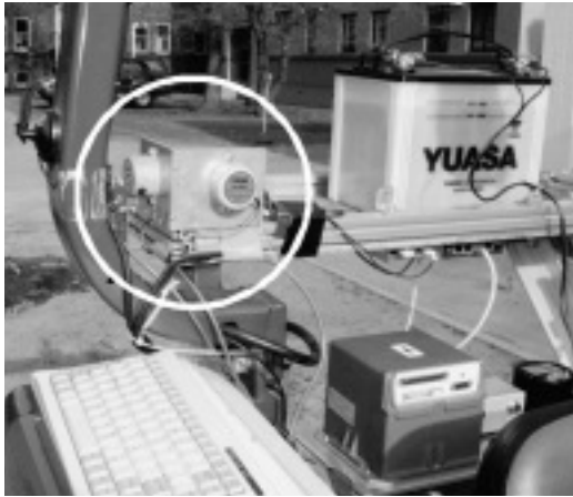
図 3.4 傾斜計とその配置
