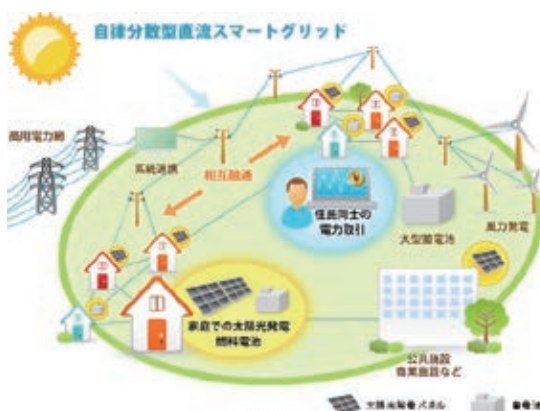
図2. 自律分散型スマートグリッドi-Reneの概略図
