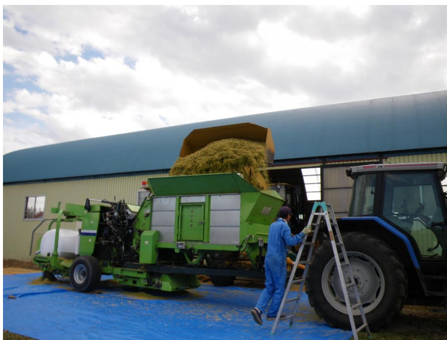
図 2.3 細断型ロールベアラへの材料投入
