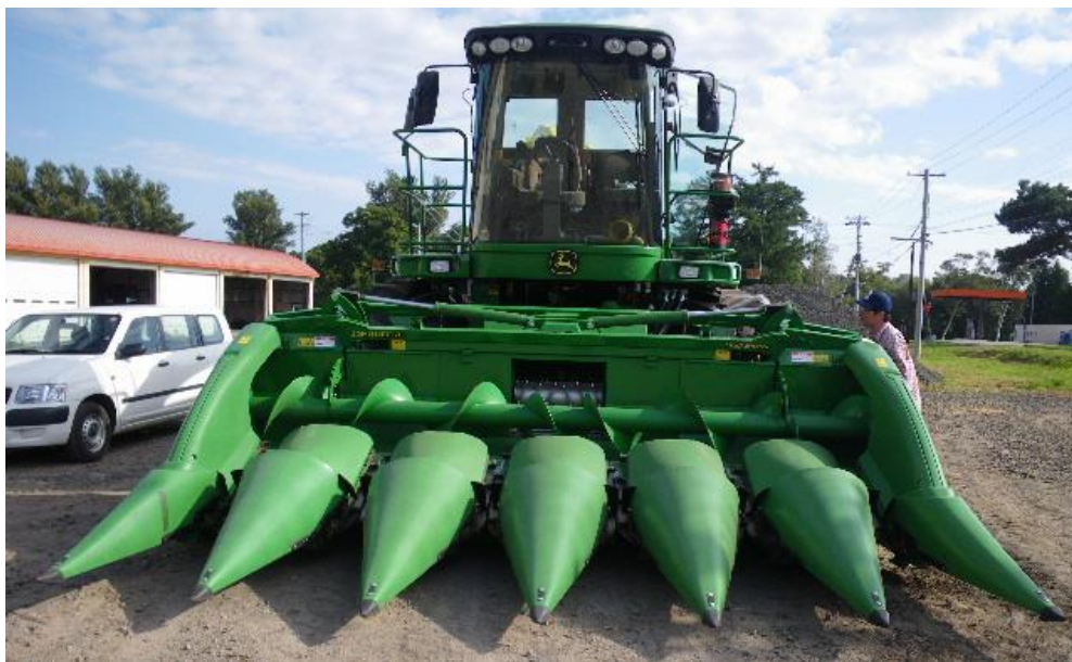
図 2.1 スナッパヘッドを装着した自走式フォレンジハーベスタ
