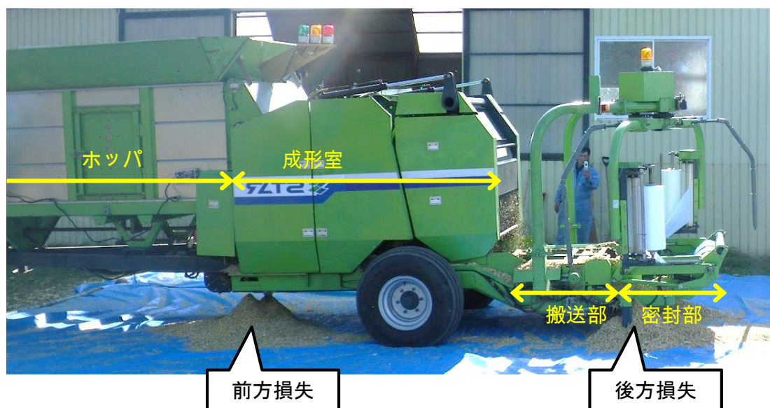
図 3.1 細断型ベアラの各部名称と損失量の計測箇所
