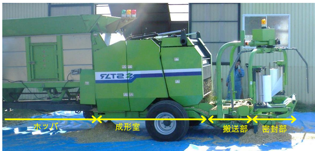
図 2.5 細断型ベアラ各部の名称
