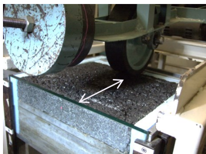
図1-1 室温45℃で、アスファルト混合物の試料（5×30×30cm）に、トラック相当の車輪を60km/hで繰り返し走行させる。CCDカメラを用いたひずみ測定器は、ガラスで保護された側面から、6mm 2 単位毎に生じたひずみ（最小:100×10 -6 （100マイクロン））と、そのひずみの方向を瞬時に測定する。（ドイツGOM社のARAMISシステム）
