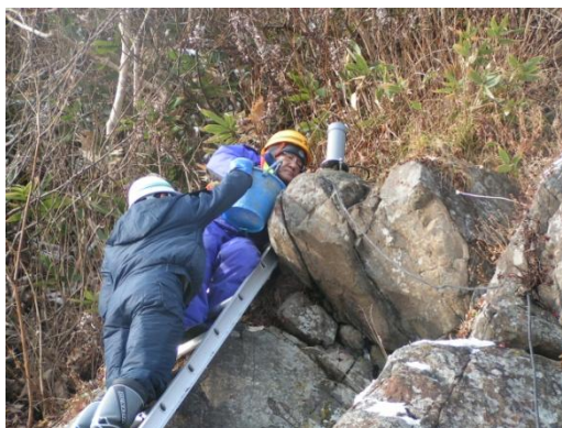
図9 岩体 A への据え置き型傾斜計の設置の様子
