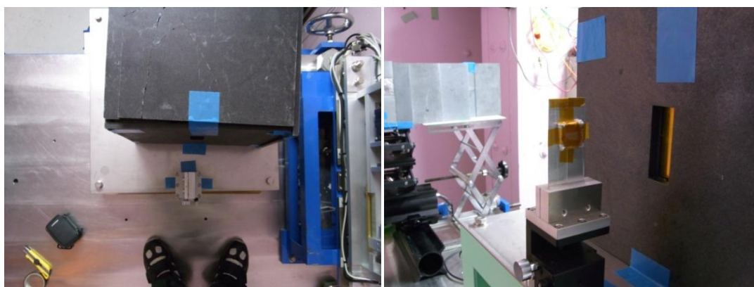
図 3.27 : シングルバンチ実験における試料と検出器のセットアップの様子。右は試料及び検出器を上から見た様子であり、写真の右側に写っているのは B_4C スリットのフレームである。左はビームライン上流側から試料を写した写真である。
