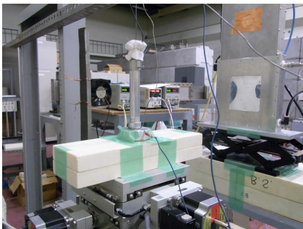
図 A.4 : 二重円筒試料と検出器の写真。この写真は図 A.3 とビームの方向を揃えるために左右反転させている。
