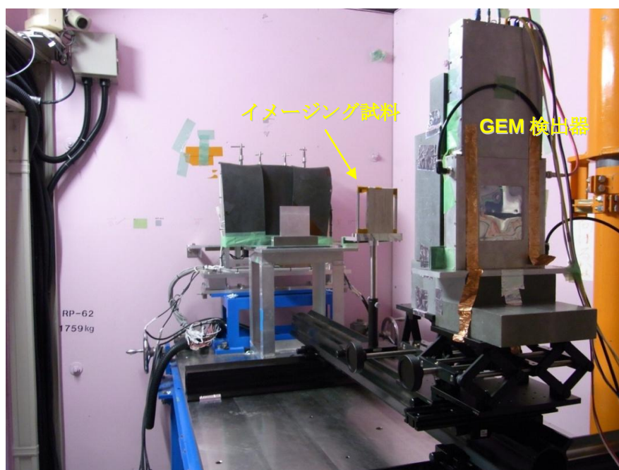
図 5.3 : イメージング試料と検出器のセットアップの様子。写真には第 4 章で説明した BR フィルターが写っているが、本章における解析では使用していない。
