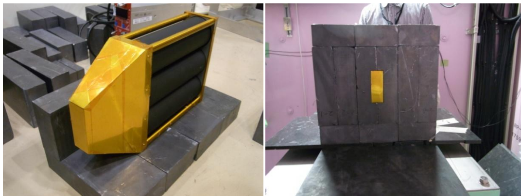
図 3.13：プラスチックシンチレーション検出器の外観（左）と検出器周りの遮蔽の様子（右）。ここで示している遮蔽は \gamma 線に対する鉛遮蔽のみである。
