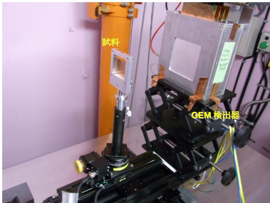
図 4.15 : Cu 板試料と GEM 検出器のセットアップの様子。Ag 板も同様にセットした。
