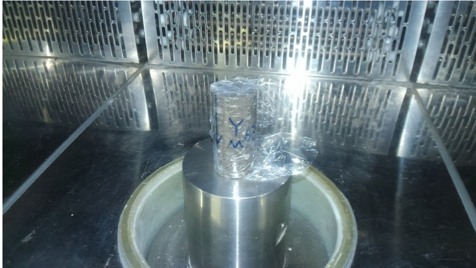
図 2.13 恒温槽内に静置した供試体
