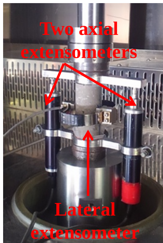
図 2.7 変位計の設置状況
