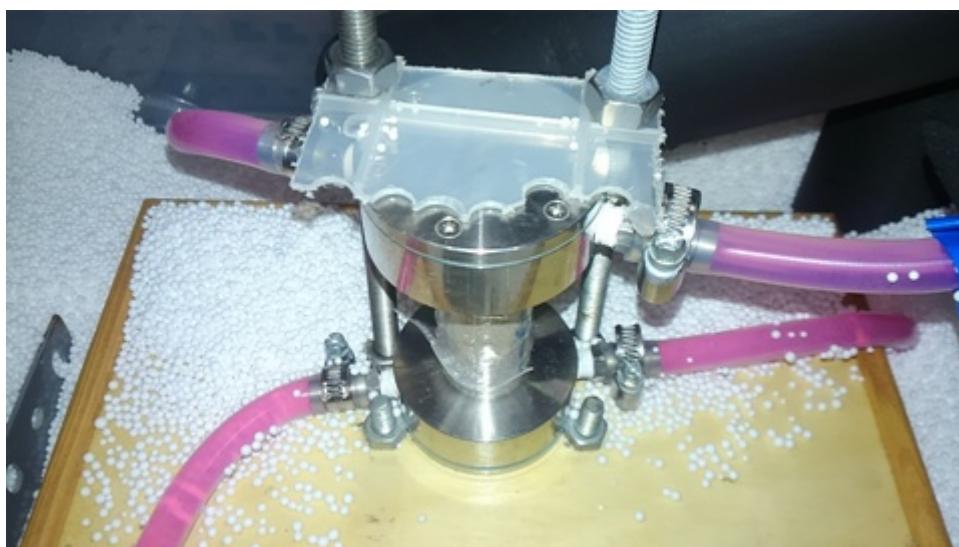
図 2.12 一次元冷却システムに設置した供試体
