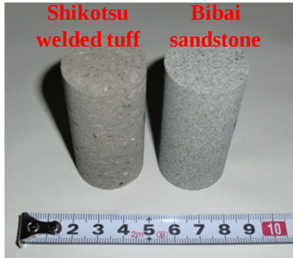
図 2.4 作製した供試体(左:支笏溶結凝灰岩、右:美唄砂岩)
