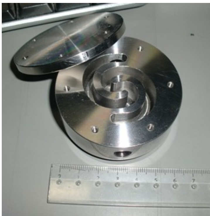
図 2.11 金属ピースと内部の水路
