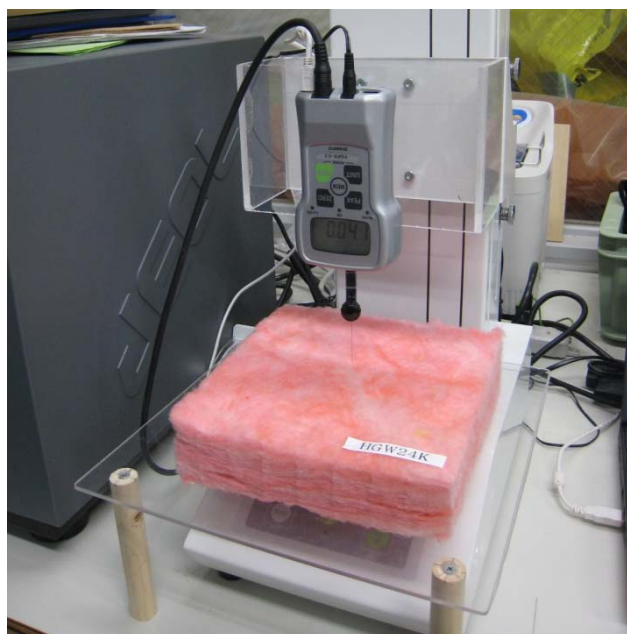
写真 4-8 突き刺し試験の状況
