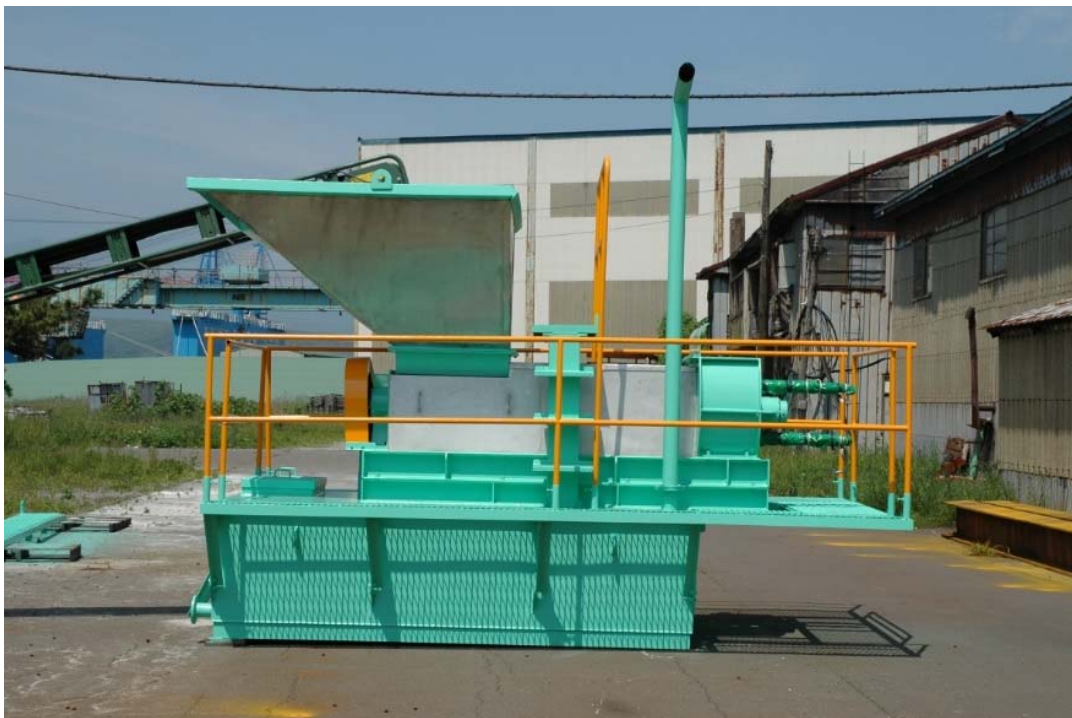
図 2.1 スクリュープレス型固液分離機 SD-300 の概観
