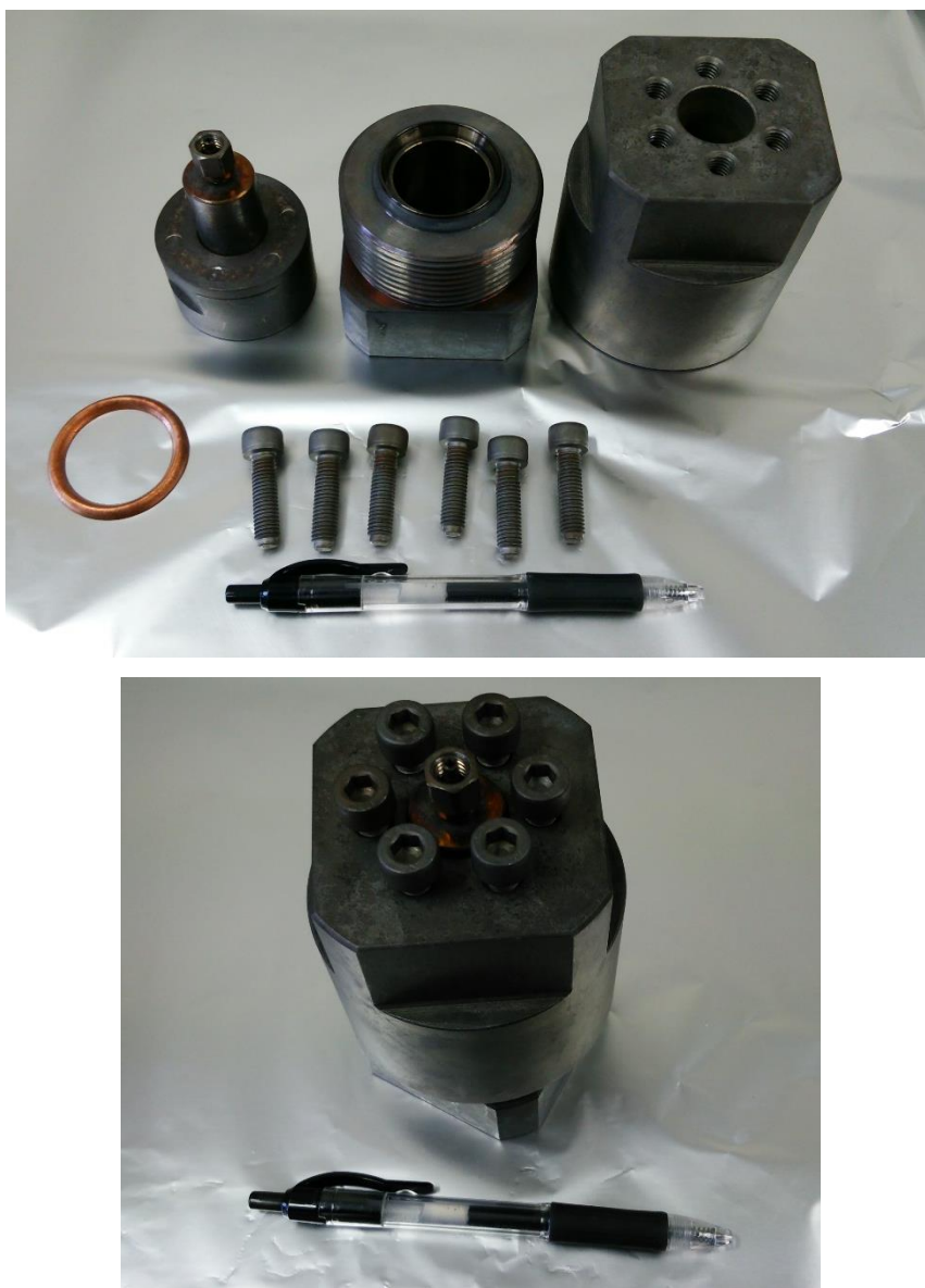
図 2.4. 日東高圧社製高温ミニリアクターの写真. (上) 組立前 (下) 組立後.
