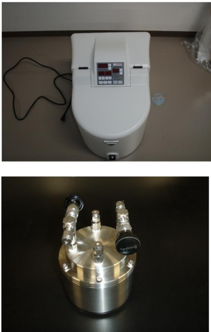
図 3.3. (上) P-6 型遊星ボールミル回転粉碎機と (下) 石炭専用ボールミル (容積 100.98-mL)
