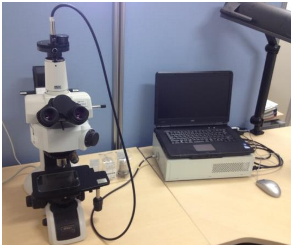
図 2.10. (左) Nikon ECLIPSE LV100BD 反射顕微鏡と (PC 下) 浜松ホトニクス株式会社製マルチチャンネル分光器 PMA-12.
