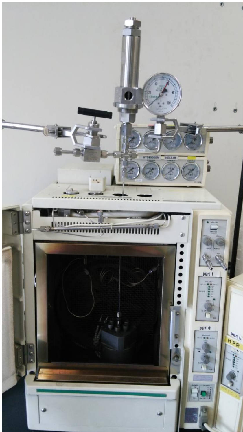
図 2.5. 熱分解装置外観：日東高圧社製の高温ミニリアクターに GC オーブンを組み合わせて作成した。
