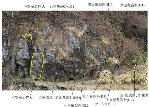
図1 計測対象の岩盤と計測装置の様子
