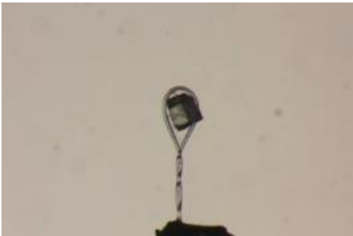
図 17 インクジェットでのゲル溶液の塗布後の様子
