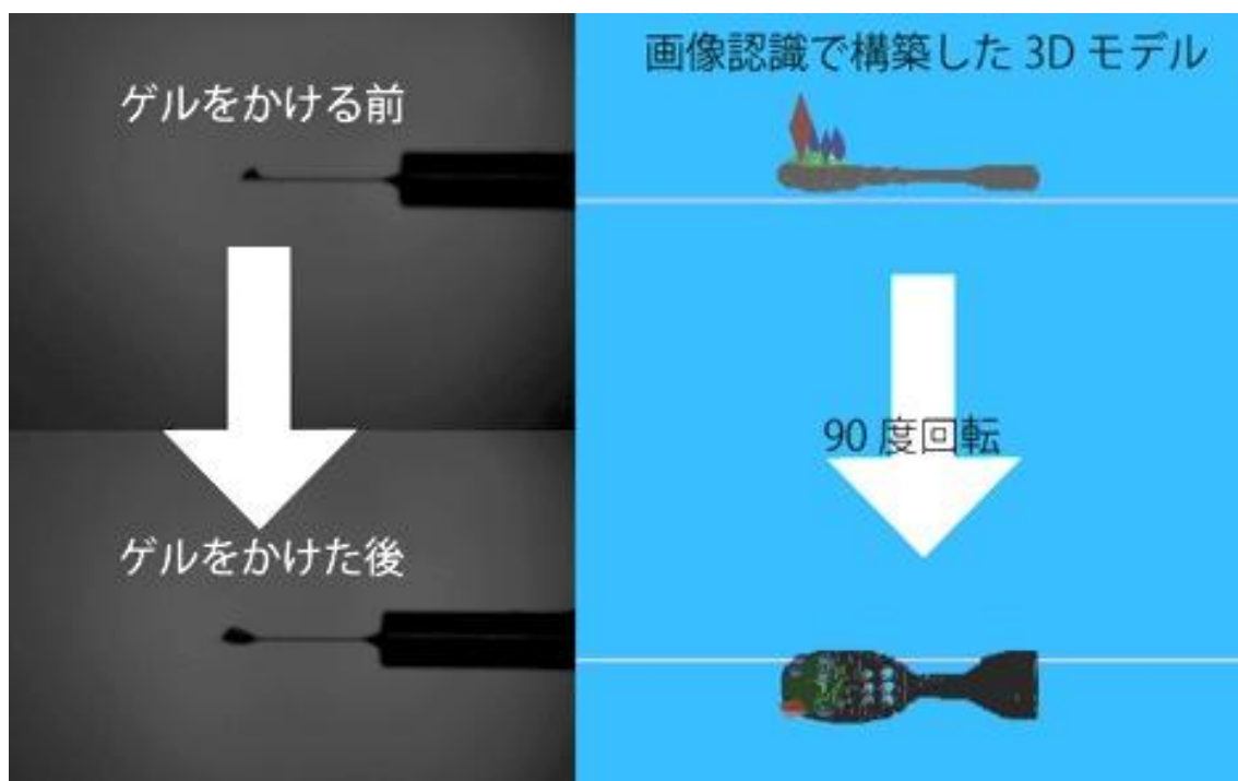
図 44 ゲルを結晶にかける様子。(左) 顕微鏡カメラの画像 (右側) 構築した 3 次元モデルであり、灰色の部分がループ、緑色の部分が結晶として認識された部分である。また、赤及び青のマーカーはゲルをかける位置として決定した場所である。
