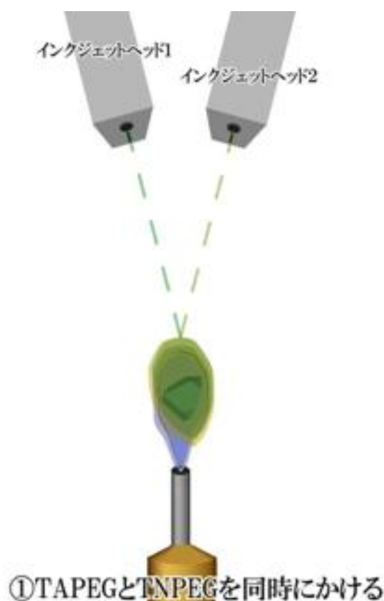
図 11 インクジェットを用いたゲル溶液の配置の模式図。TAPEG および TNPEG は Tetra-PEG ゲルの A 液および B 液を表す。
