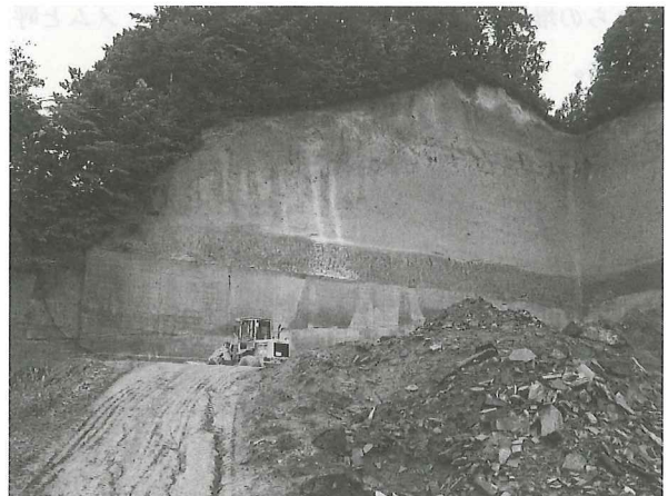
図 8-47 札幌軟石採掘現場の南壁面 中央の黒い水平の筋から下部が石材となる固結した火砕流堆積物である。
