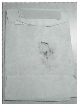
図2 カビの発生したガラス乾板、乾板を くるむ半紙からカビが発生した例
