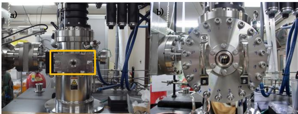
図 2.1 マイクロ波プラズマ CVD 装置 ASTeX AX5250 試料導入部
