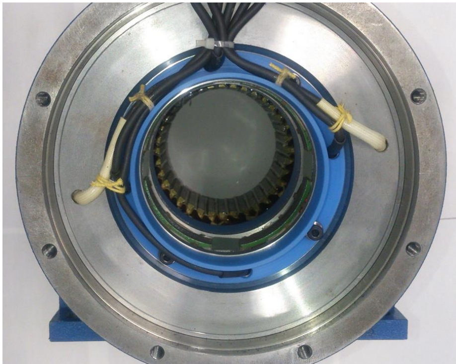
図 5-6 提案する R+TMB Type B ver1 を備えた試作機の R+TMB Type B ver1 部固定子
