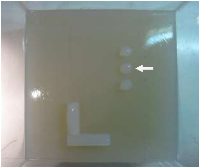
図 2 寒天とヨード造影剤で作成したファントム（作成の途中） 3つの球状構造のうち、矢印の球状構造（標的）にヨード造影剤を 5%混入した L字型の構造は標的の位置情報をもたらすランドマーク（ヨード造影剤入）
