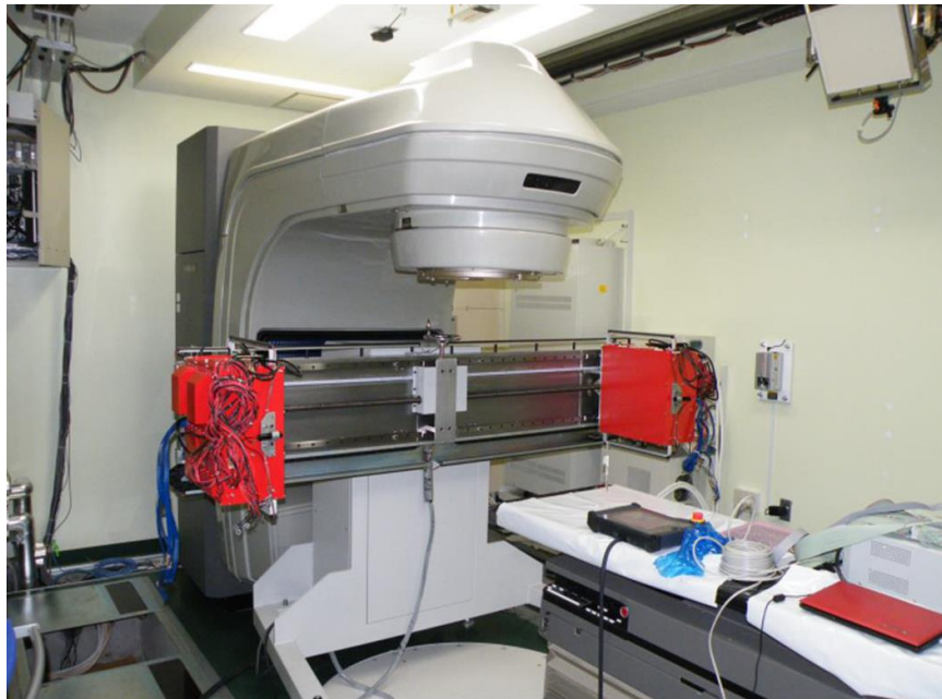
図 5-1 対向型 PET 装置実証機。対向する検出器ユニットは、総合制御ユニットによって同時計数が行われ、データが処理用 PC に転送される。
