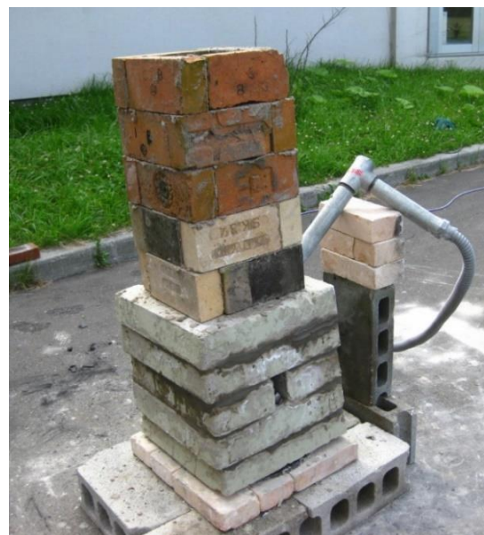
図 2-35 耐火レンガを積み上げる
