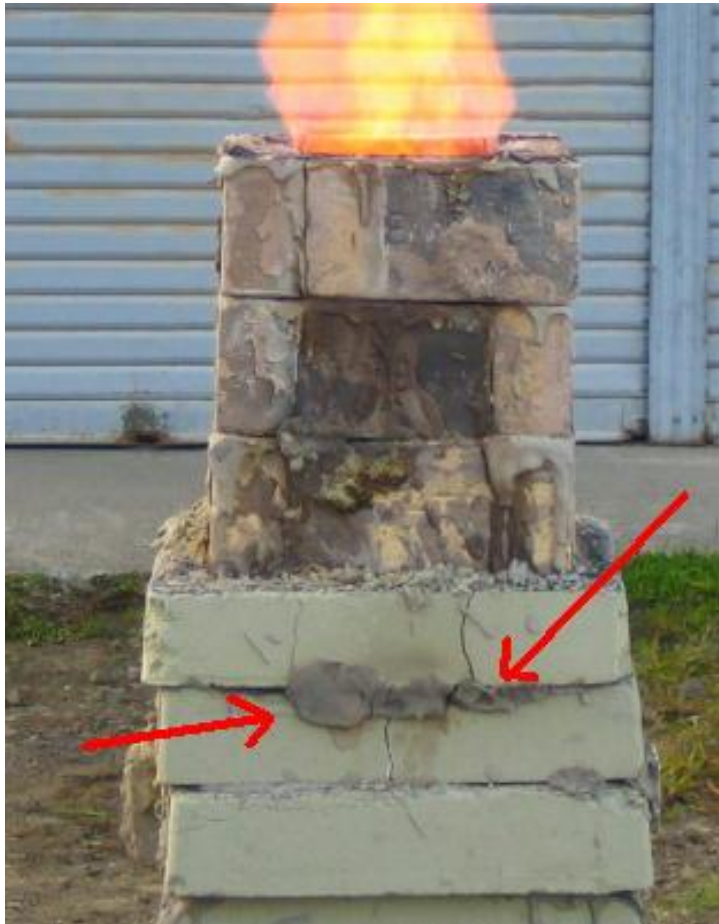
図 2-24 レンガ接合部分の隙間から炎が吹き出す
