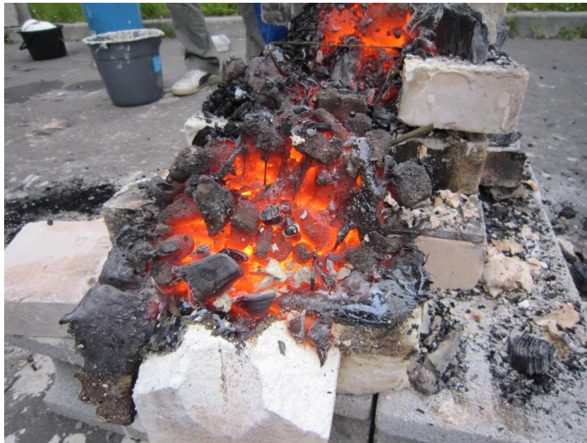
図 3-5 流出せず内部でガラス化したノロ
