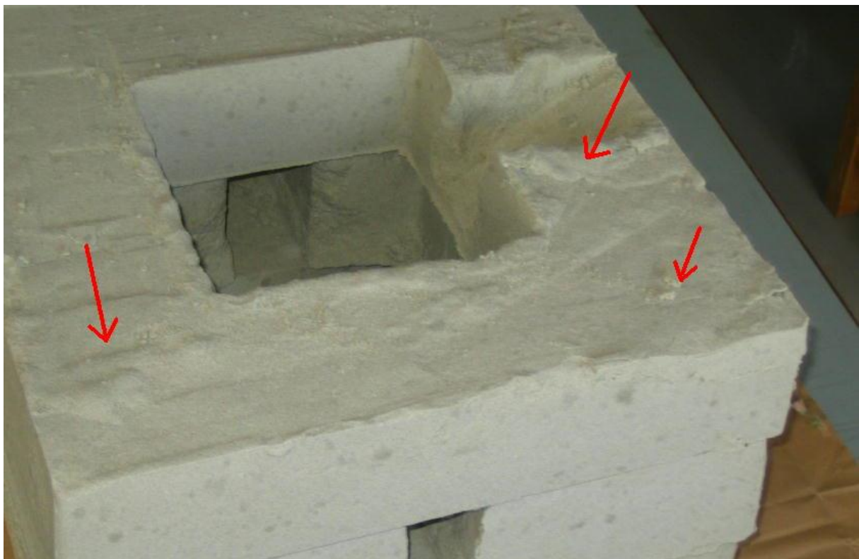
図 2-23 レンガ面の凹凸が未処理である
