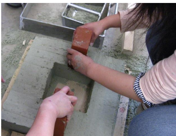
図 2-31 ノロ出し口の加工
