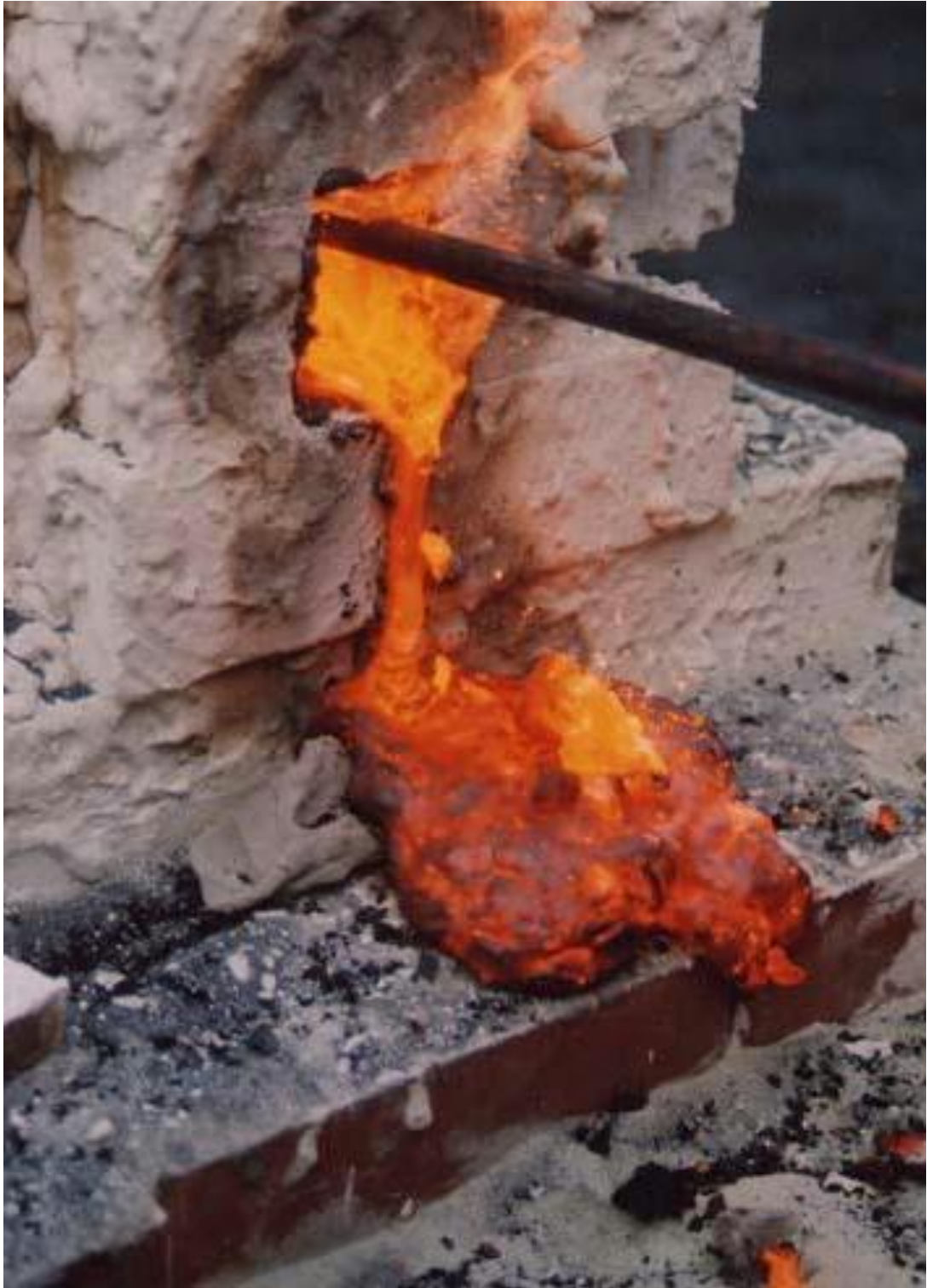
図 3-4 粘性の高いノロの流出
