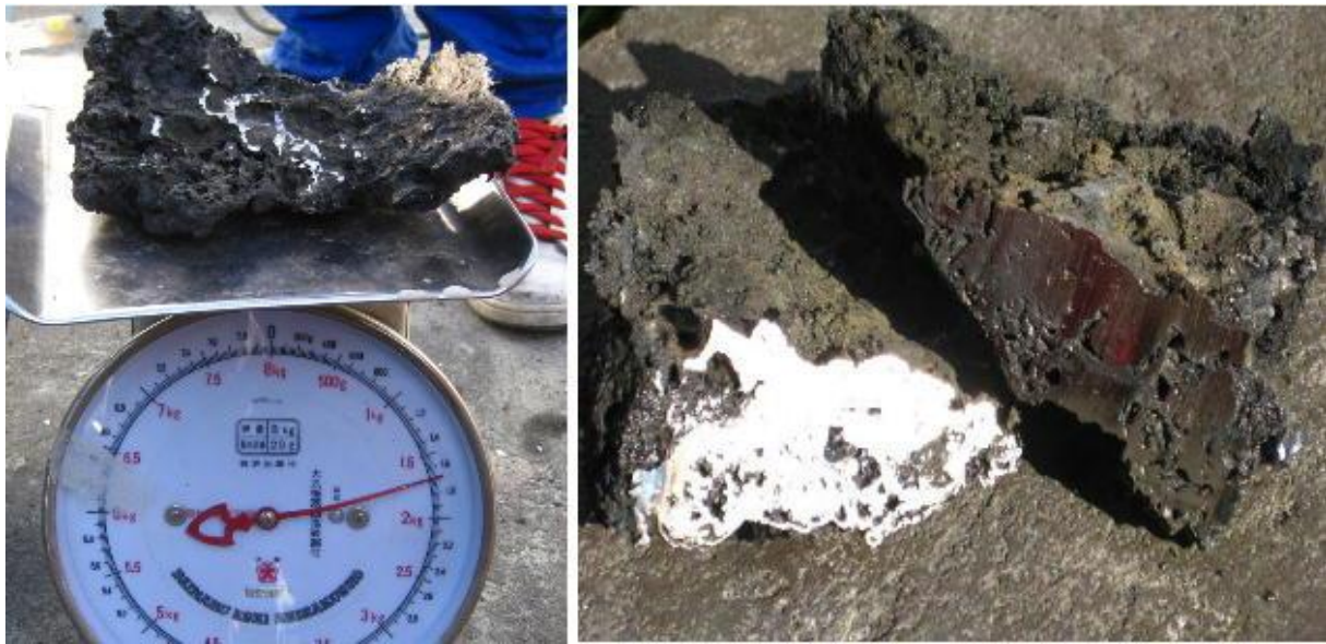
図 2-44 2009 年の歩留 21%のケラと切断面
