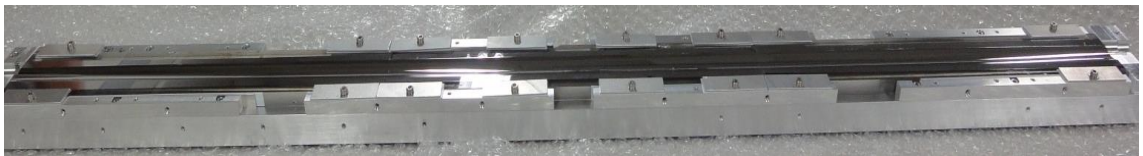
図 1-4. mfSANS で使用した回転楕円形状の集光ミラー
