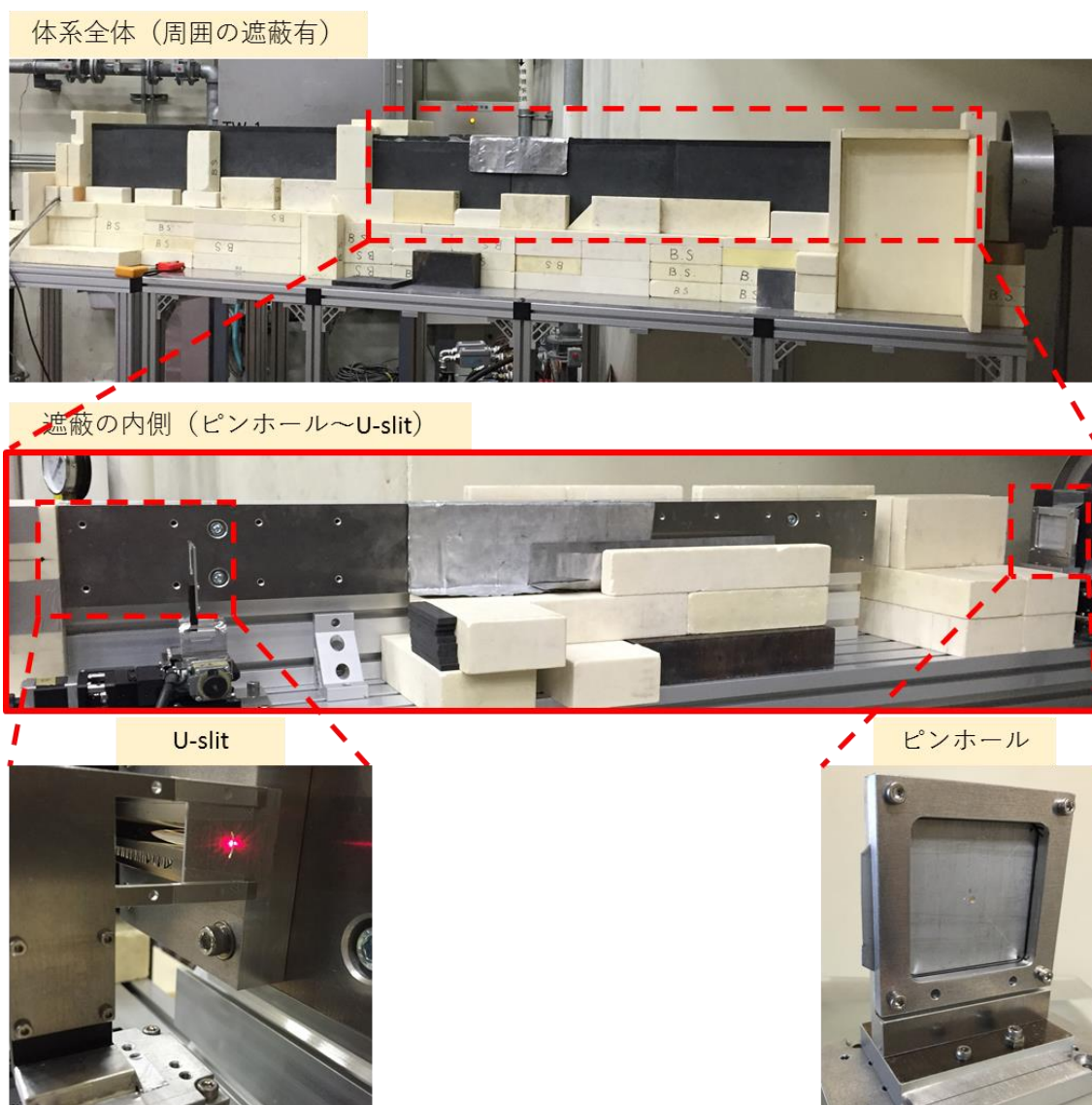
図 3-15 HUNS で組み上げた中性子反射試験の実験体系。
