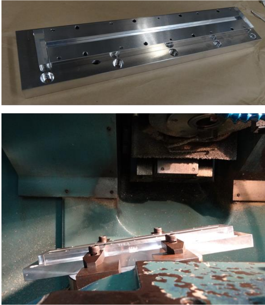
図 5-3. 形状形成前のミラーの写真（上）と加工機に傾けた状態でミラーを固定した状態の写真（下）
