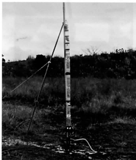
図 6 発射台に据え付けられた大型ペットボトルロケット (2014 年 3 月 26 日、コスモパーク加太にて第一著者撮影)
