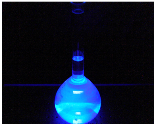
図 3.2 紫外線を照射され蛍光を発するピレン酪酸水溶液.
