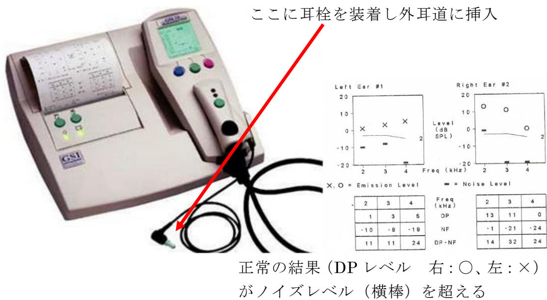
図 4 DPOAE 測定機器の一種 (GSI-70 system®, Rion Co. Ltd., Tokyo, Japan) (文献 12 より改変して引用)
