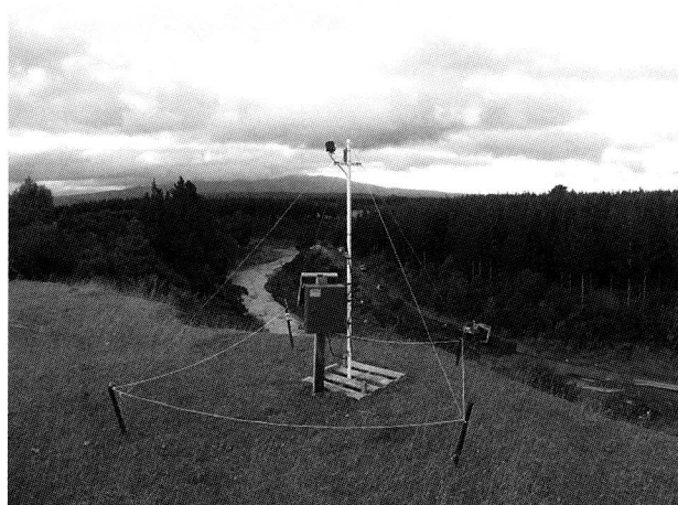
写真-8 ラハール観測のためにストラッチャンズ橋付近に設置された自動撮影スチールカメラ (遠景はルアペフ火山、手前の川がワングエフ川)
