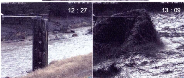
口絵写真－6 タンギワイ鉄橋上流の洪水観測塔(Lahar sensor tower)に衝突するラハール (観測塔上部に張り出しているアームは、非触水型水位計。)
