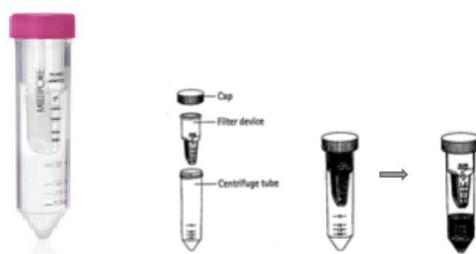
図 3 Amicon Ultra-15 Centrifugal Filter Devices 3K を用いて培養上清を分画化した。
