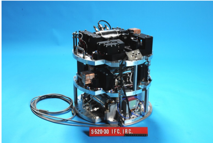
図 6. 4. 搭載実験装置メイン部外観. 上から二段は, 実験チャンバーとマッハツェンダー型干渉計を一对とした実験装置が搭載されており, 三段目に IRC が搭載されている. 加速度計が二段目に設置されている.
