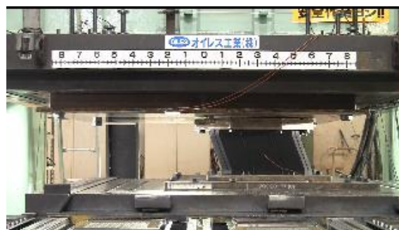
実験 No.1-2-04 ( 4\text{N/mm}^2 , 最大変位+798mm [注]制御ミスにより最大変位 900mm 付与)
