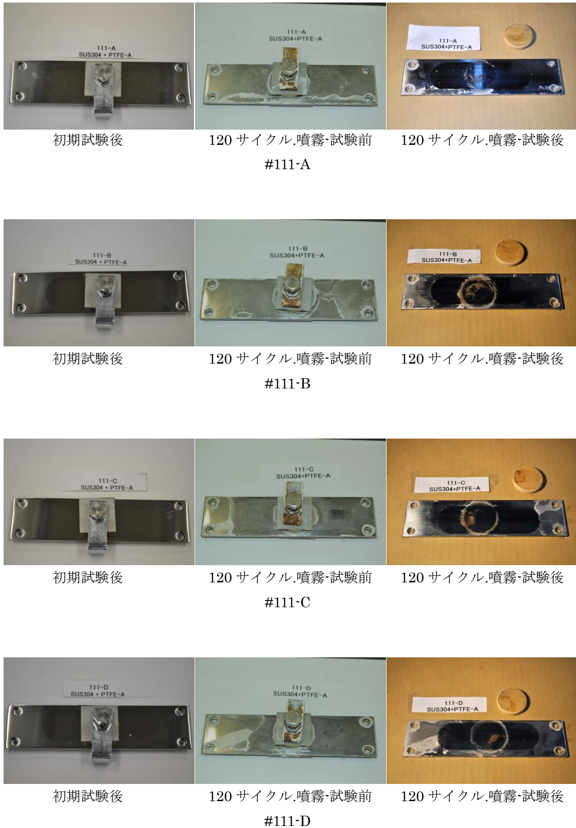
図-4.3.32 #111 試験体写真 (PTFE-A-SUS304-120 サイクル噴霧)
