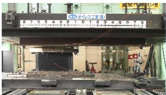
実験 No.1-2-04 ( 4\text{N/mm}^2 , 最大変位+798mm [注]制御ミスにより最大変位 900mm 付与)
