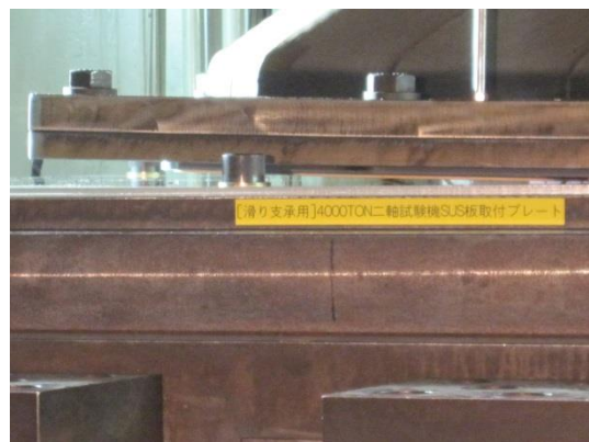
図-3.3.7 面圧 30N/mm 2 載荷・揺動時のすべり面浮き上がり状況（試験体 No.1）
