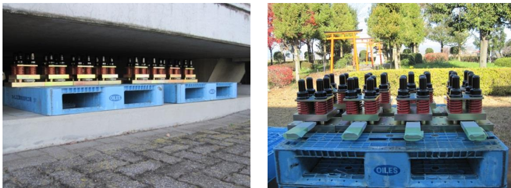
屋外暴露状況（左：免震層 右：完全屋外）
