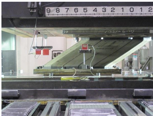
図-3.3.7 面圧 30N/mm 2 載荷・揺動時のすべり面浮き上がり状況（試験体 No.1）
