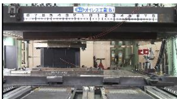
実験 No.1-2-08 ( 8\text{N/mm}^2 , 最大変位+860mm)
