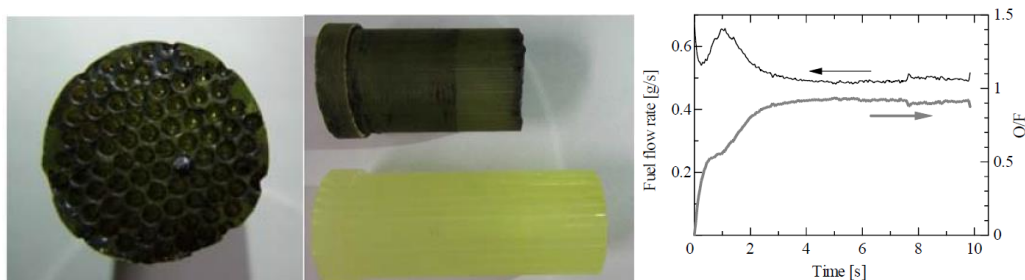
図 1.15 燃焼実験後の燃料（燃焼面と軸方向）と燃焼実験結果 [41]
