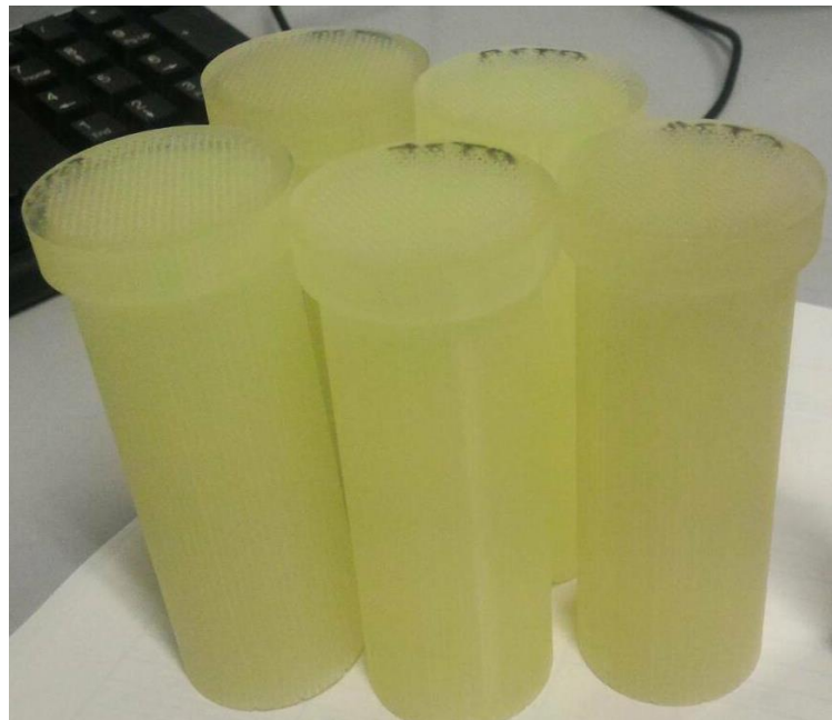
図 2.33 高精度 3D プリンタによって成形された大型燃料 [56]
