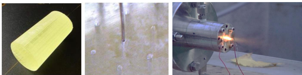
図 1.14 3D プリンタで成形された燃料と燃焼実験の様子 [41]
