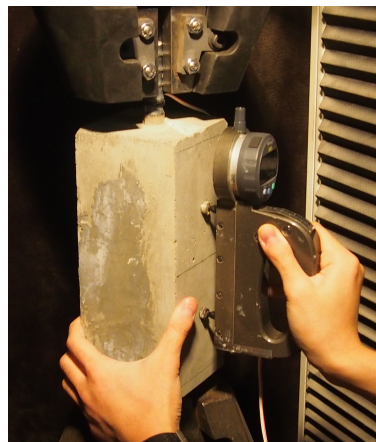
図-2.4 コンタクトチップによるひび割れ幅の計測
