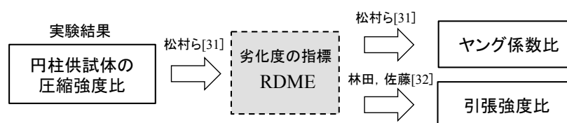
図- 2.36 提案した構成則の検証に用いるコンクリートの損傷度の推定
