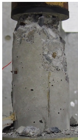
図-2.10 円柱供試体の破壊形式
