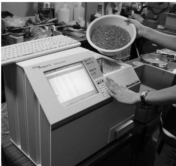
図1 近赤外透過型分析計による小麦の測定
