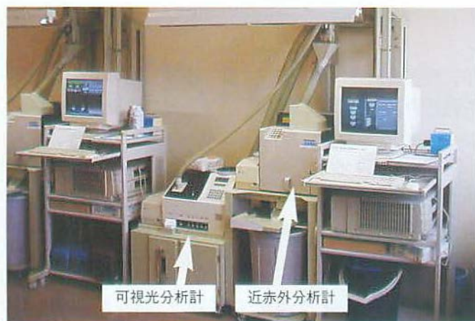
写真-2 籾の自動品質検査システムの実例 (この施設では二組のシステムを使用している)
