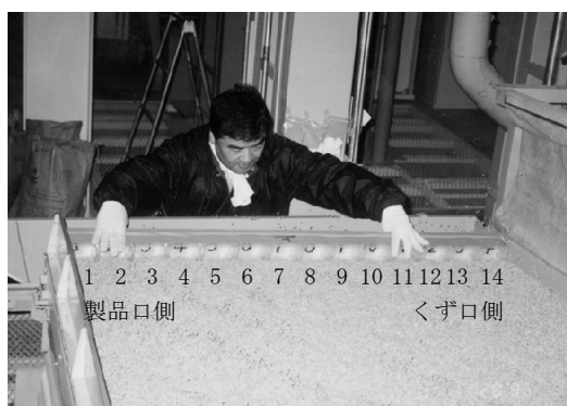
図9 比重選別機の選別口14等分試料の採取
