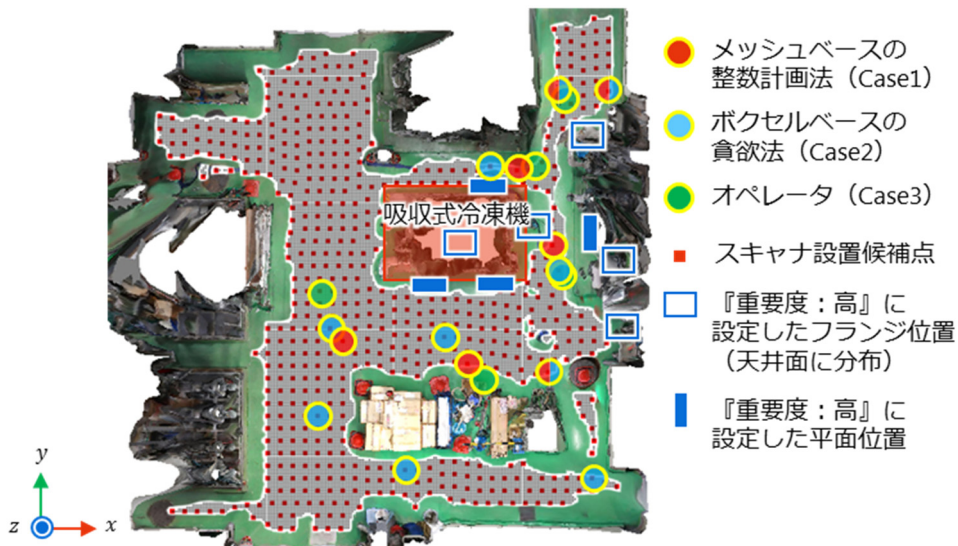
図 3.17 各ケースのスキャナ配置の比較 (熱源機械室)
