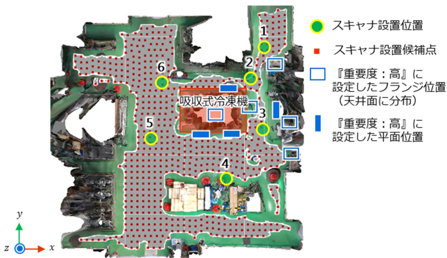
図 2.54 熟練オペレータによるスキャナ配置結果（熱源機械室）
