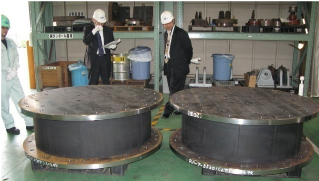
写真 2.1 外径 1300mm の積層ゴム試験体 RB1300 (6. 4)
