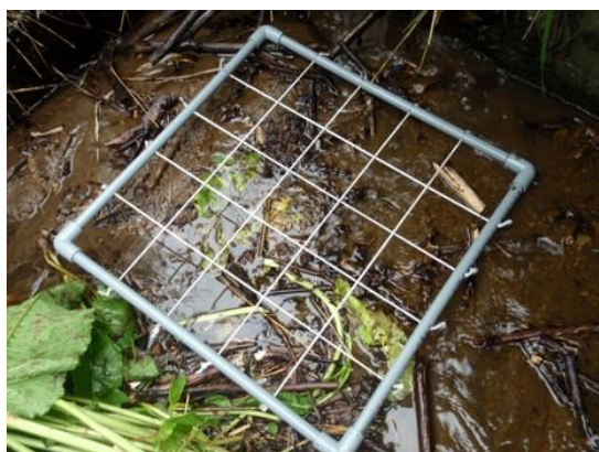
図 3.11c 集水枡に堆積した礫の状態 泥砂中心で草本が生育して いる (田中一典撮影)
