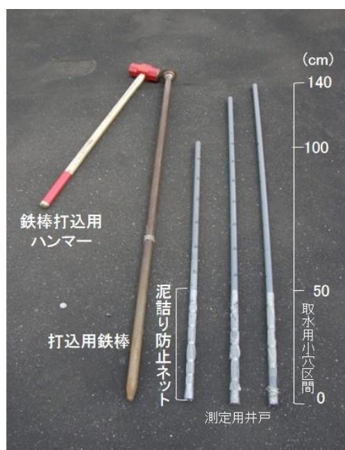
図 4.3 河床間隙水位測定用の井戸 （田中一典撮影・説明挿入）
