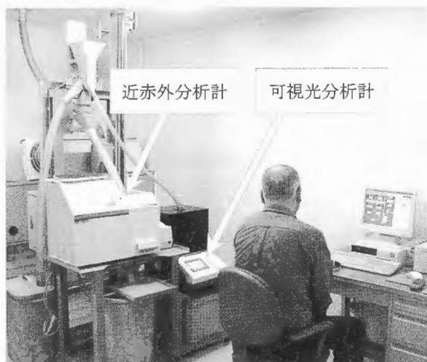
図4 米の自動品質検査システムの一例
