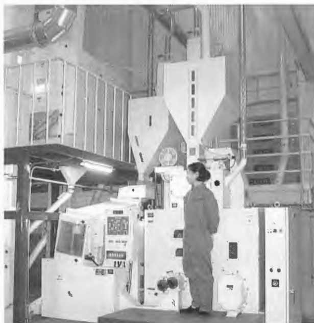
図14 共乾施設の粳摺システム (ロール式粳摺機と風力選別機および揺動選別機とを組み合わせたシステム)
