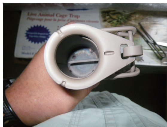
写真 2 前脚拘束式わなのトリガー
