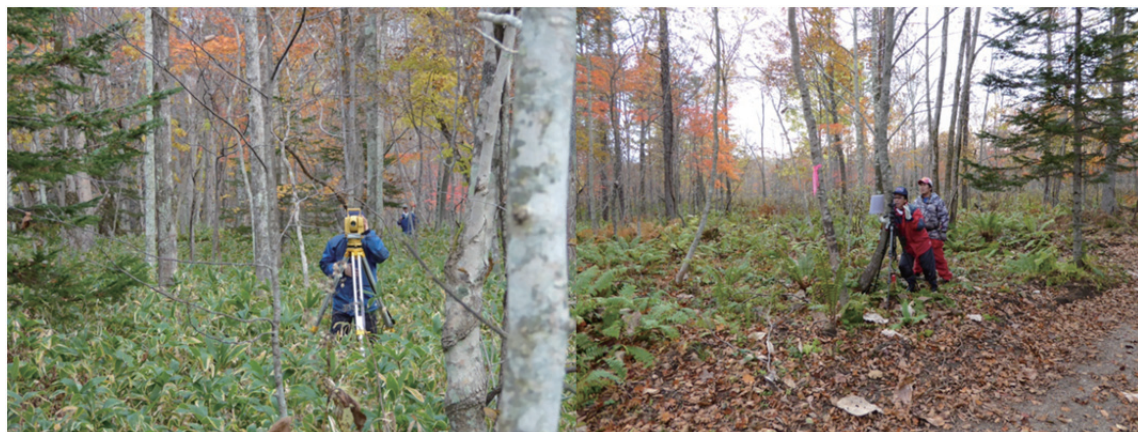
図 3 林床植生の異なるエリアでの測量風景。今回はトータルステーション（左）を基準にしたが、試験的に簡易レーザー距離計による計測も一部で実施した（右）。
