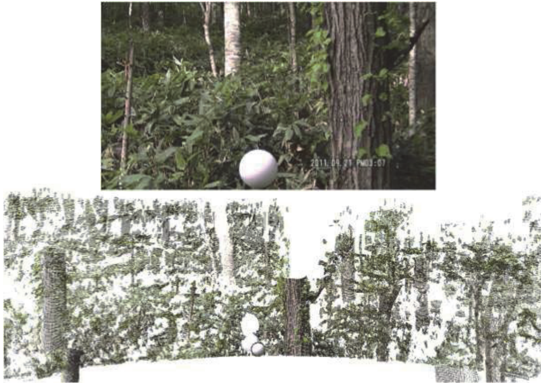
写真 3. ビデオ画像(上)と林内レーザー・スキャナーで得られた点群集(下)のデータの比較 (共同研究者：千葉大学 本多嘉明先生、梶原康司先生、小野朗子先生)
