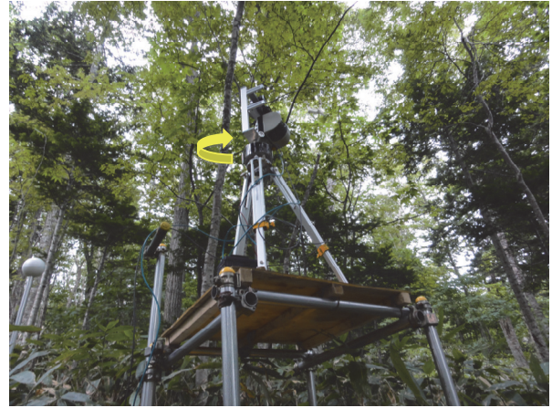
写真 2. 林内レーザー・スキャナー測量による林内の空間構造の定量化
